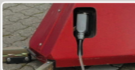
Sæt stikket fra kontrolpulten i motoren.
