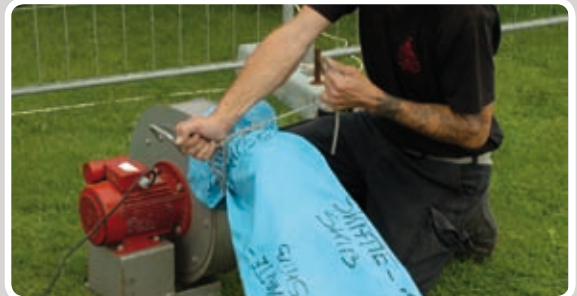
Monter studsene på blæseren.
